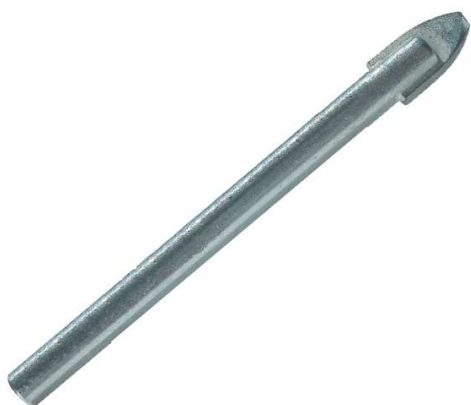
Foret carbure pour le perçage du verre. Bien lubrifier, utilisation rotation uniquement
